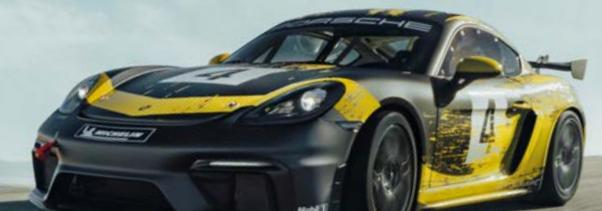
Ein Ergebnis des Projekts ist, dass die Porsche AG im Januar 2019 erstmals ein in Serie produziertes Rennfahrzeug mit Karosseriebauteilen aus Biofaser-Verbundwerkstoffen auf den Markt gebracht hat. Beim neuen 718 Cayman GT 4 Clubsport sind die Türen und der Heckflügel aus einem Naturfasermix hergestellt.
